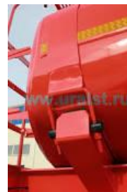
Sistemul de ancorare pentru fixarea cisternei pe șasiu
