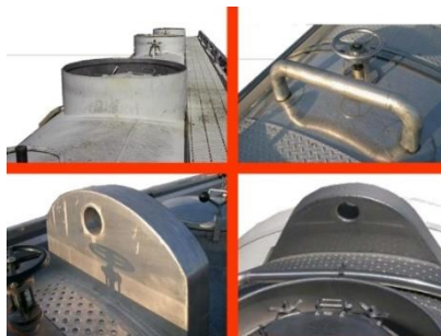
Arcurile tubulare sudate sau fixate pe părțile laterale superioare, fixate pentru protejarea echipamentului de serviciu în caz de răsturnare
