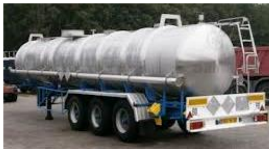
Inele de întărire exterioare ale rezervorului
