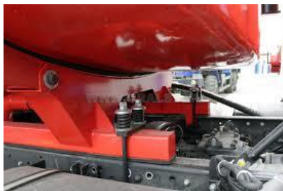
Sistemul de ancorare pentru fixarea cisternei pe șasiu
